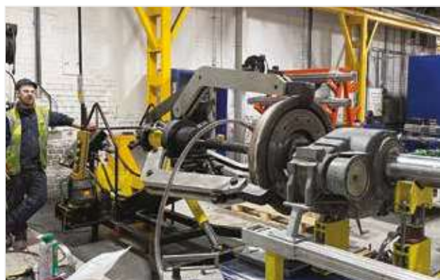
◀ LGH3100 utilisé pour extraire une roue ferroviaire de l'essieu.
